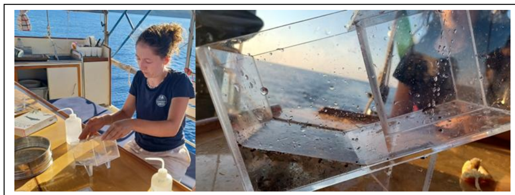
Figure 6 : Utilisation de la boîte de Motoda dans le but de diviser un échantillon en deux sous-échantillons identiques
