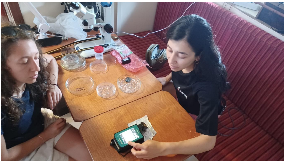
Figure 7 : Utilisation du RAMAN Mira afin de déterminer les polymères constitutifs de la particule plastiques analysée
