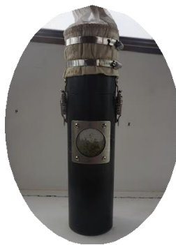
Figure 4. Collecteur permettant de concentrer les microplastiques
