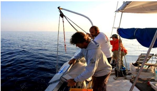
Le lancement et la récupération du Manta sont désormais facilités avec la grue. Le chalut Manta possède un nouveau collecteur lesté, plus simple à nettoyer, et un filet neuf d'une maille de 300  $\mu\text{m}$ . Nous sortons donc légèrement des standards de M.Eriksen de 333  $\mu\text{m}$ , pour revenir aux standards des maillages européens.
