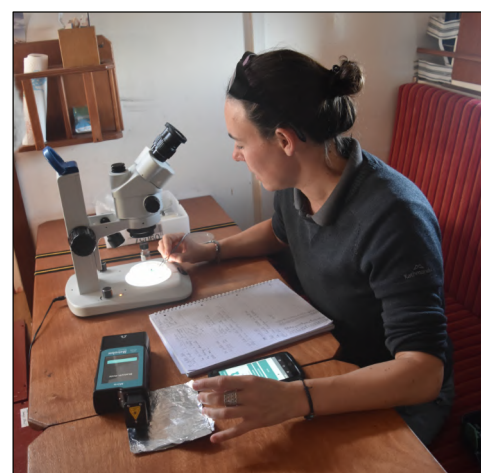
Analyse de la composition moléculaire des particules (spectrométrie Raman)
