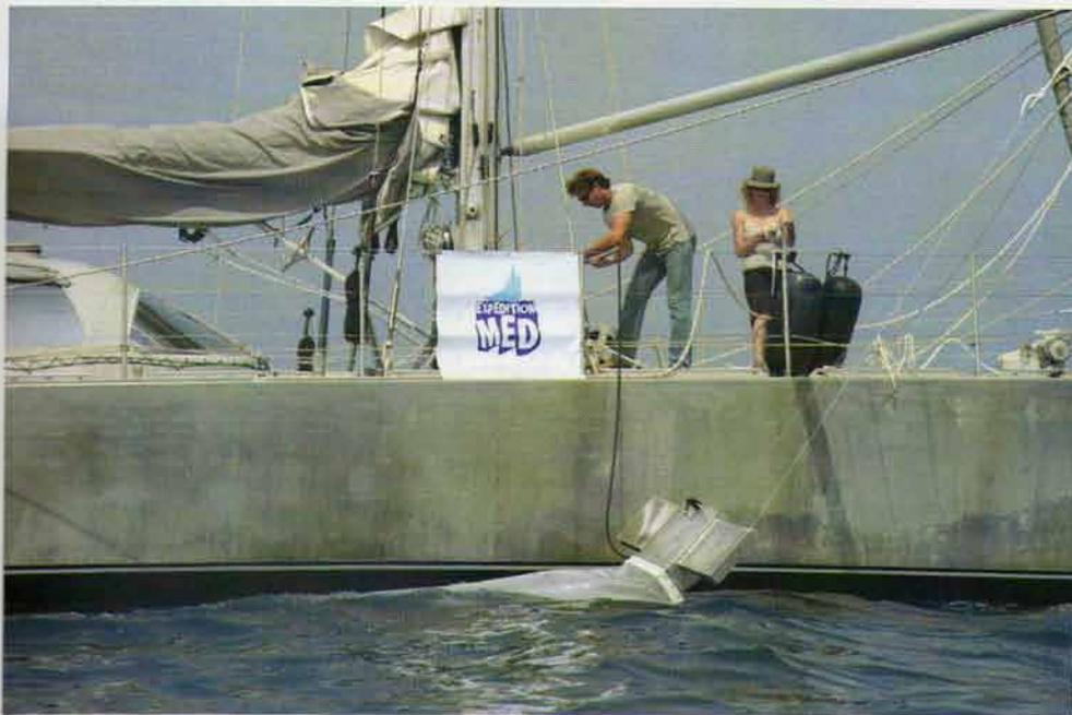
**Mise en place du manta trawl (filet à plancton. Manta trawl tracté).**
